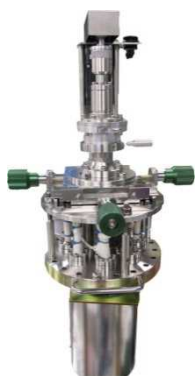
サイドエントリー型基板加熱機構
